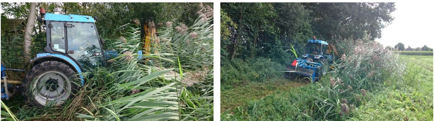
Figuur 5-11 Voorbeelden van onveilig maaien door verruiging van de onderhoudsstrook na het laten liggen van maaisel (bron: interne communicatie waterschap).
