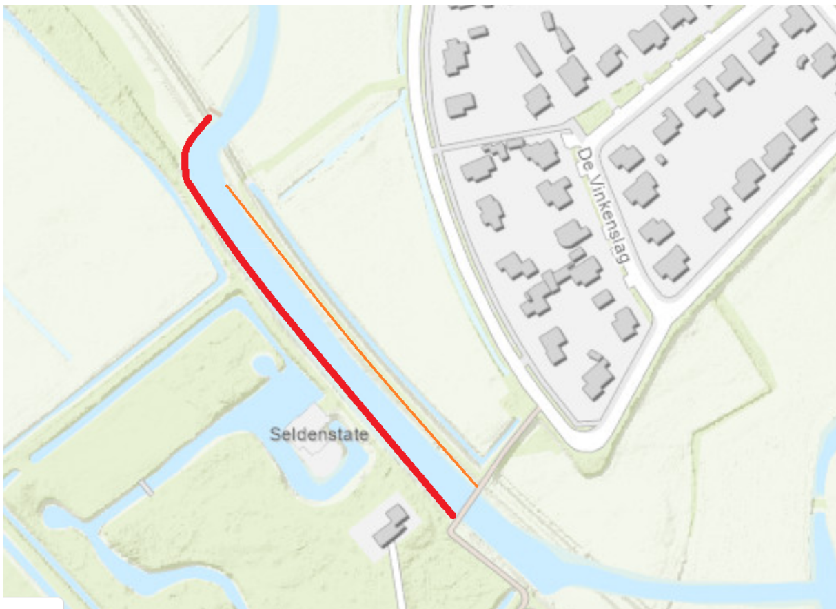
Rode lijn, betreft oeverversteving met Prolock Damwand Gele lijn, betreft de binnenbocht van de Aa, versteefd met houtpakketten en rillen
